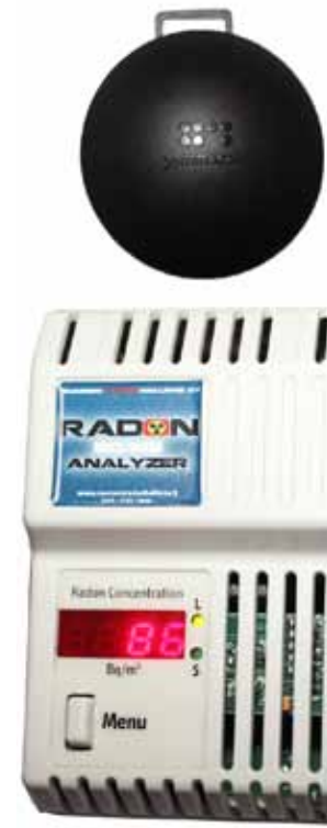
Virallisiin mittauksiin käytetään mustaa kiekkoa, joka kerää sisään tietoa kahden kuukauden ajan. Sen jälkeen tiedot analysoidaan laboratoriossa. Pikatesti kertoo tuloksia jo parin päivän mittauksen jälkeen.
